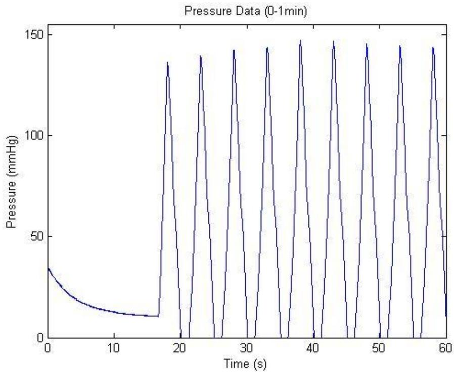
**Figure 19: Fatigue Test Pressure Data (0-1 min)**
