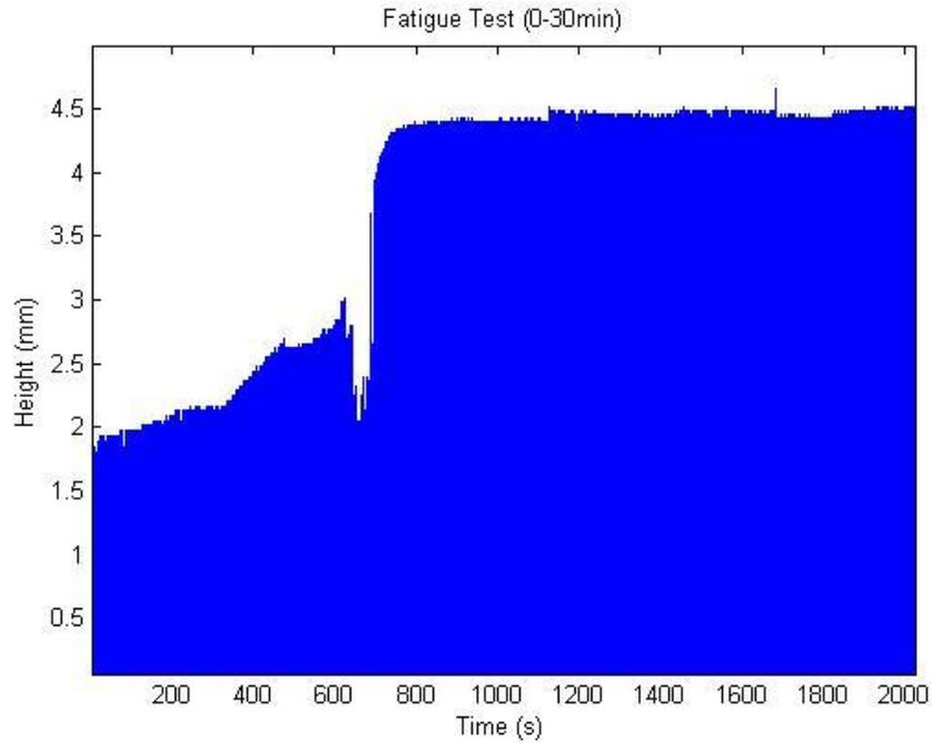
**Figure 16: Fatigue Test Displacement Data (0-30 min)**
