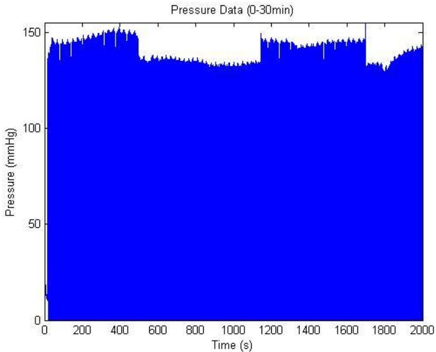
**Figure 17: Fatigue Test Pressure Data (0-30 min)**
