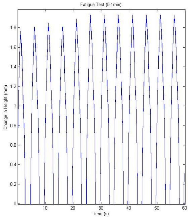
**Figure 18: Fatigue Test Displacement Data (0-1 min)**
