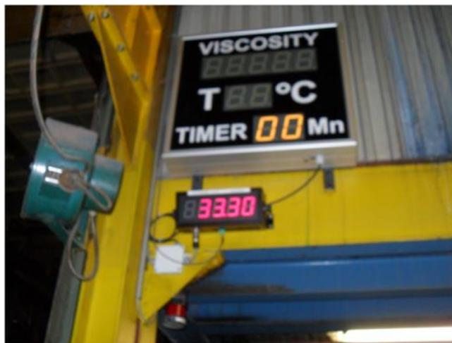
**Figure 9 : Ecran de surveillance de la viscosité et de la température du liant**
