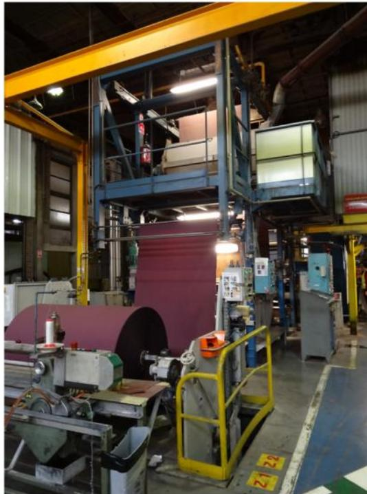
**Figure 7 : Déroulement des bobines de support**
