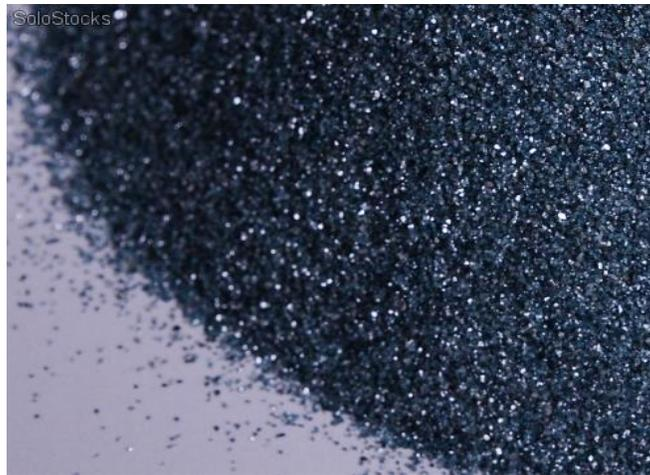
**Figure 16 : Aspect du carbure de silicium** <sup>24</sup>
