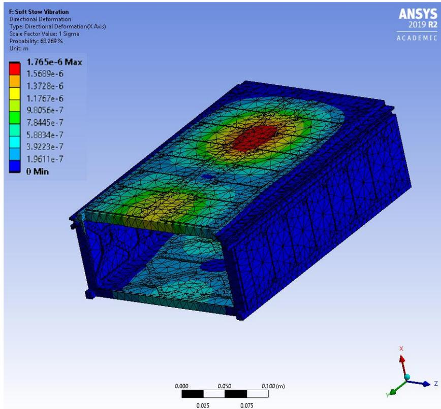
**Figure 35: Soft-Stow Deformation**
