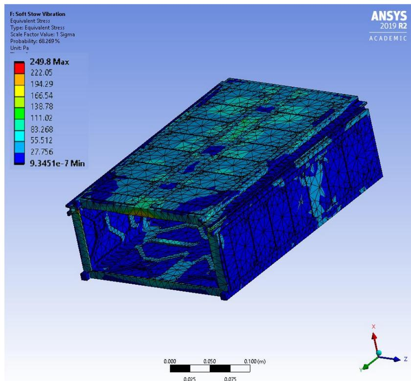
**Figure 34: Soft-Stow Equivalent Stress**
