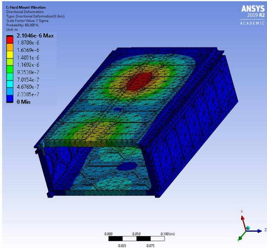
**Figure 37: Hard-Mount Deformation**
