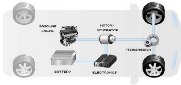
Figure 13 - Parallel Drivetrain<sup>28</sup>
