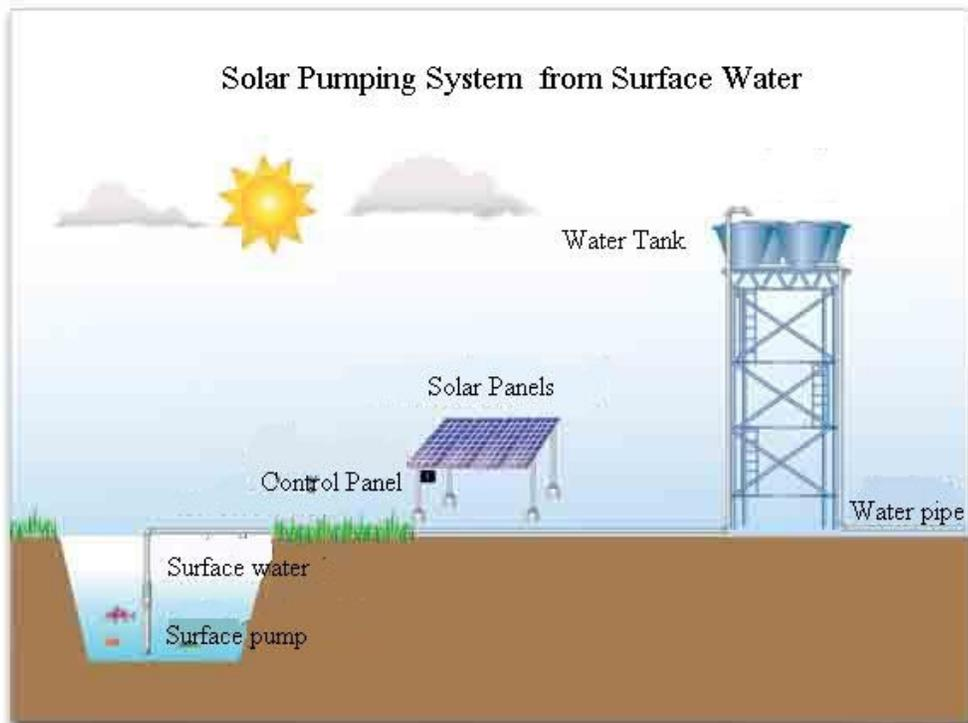
FIGURE 14: SOLAR PUMPING SYSTEM FROM SURFACE WATER
