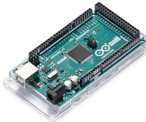
*Figure 90: Arduino MEGA 2560 [113]*
