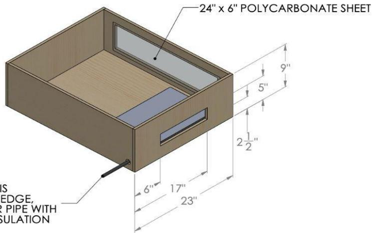
Ø 1" BURNER HOLE IS 1 1/2" FROM EACH EDGE, SURROUND BURNER PIPE WITH MINERAL WOOL INSULATION
