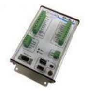
Figure : WaterLOG Storm 3 data logger (LOG, 2013).
