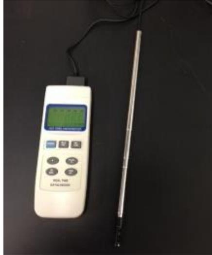
*Figure 26: Hot Wire Anemometer*
