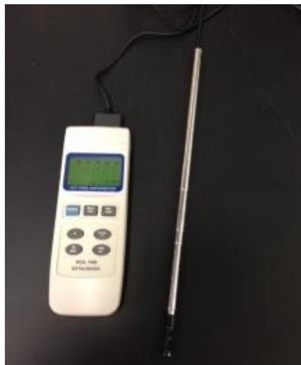
*Figure 38: Hot Wire Anemometer*
