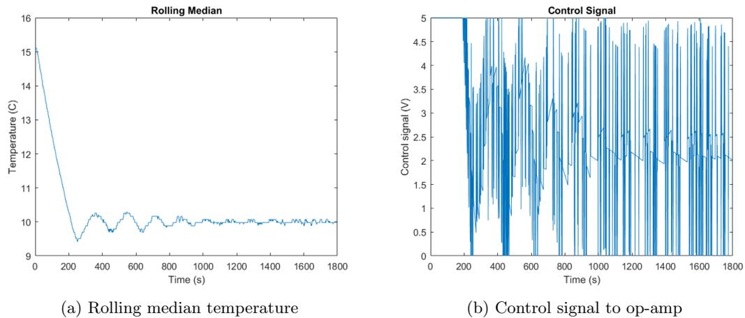
Figure 58: Rolling median,  $k_p = 5$ ,  $k_i = 0.1$ ,  $k_d = 50$
