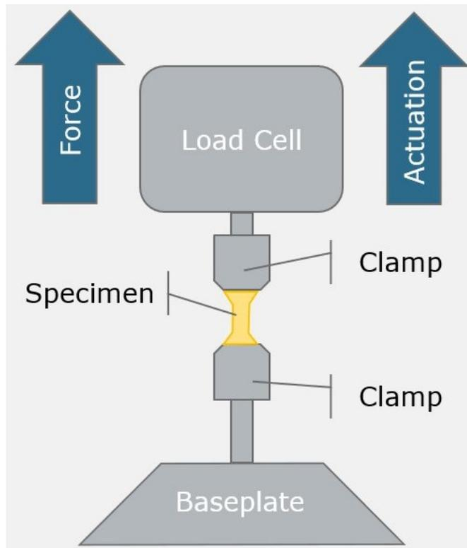
*Figure 24. Instron Setup Schematic*
