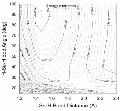
Figure 27: Se +  $H_2 \rightarrow$  Se $H_2$  (Contour Plot)
