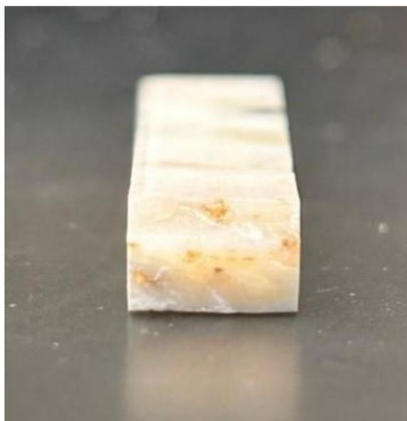
**Figure C7. CELF fiber 1 wt. % tensile fracture cross-section**
