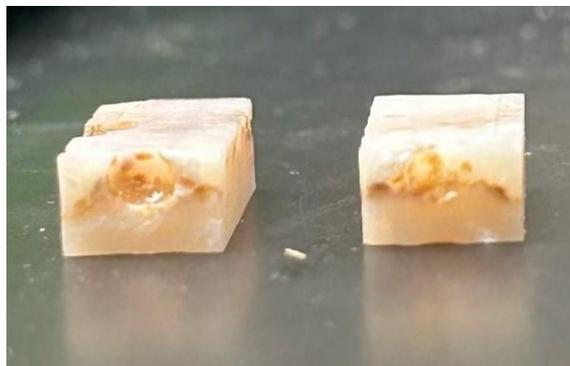
**Figure C8. CELF fiber 2 wt. % tensile fracture cross-section**
