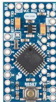
Figure 3.8: Arduino Pro Mini
