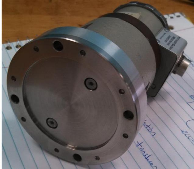
Figure 59 HBM DrehSchwungung Aufnahme Torsional Vibration Transducer
