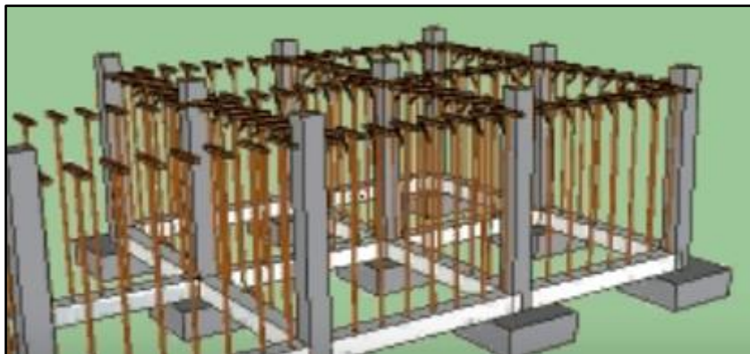
รูปที่ 21 โครงไม้ไผ่เตรียมสอดอิฐบล็อกประสาน
