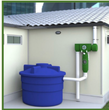
Figura 3: Sistema de recolección de agua de lluvia
