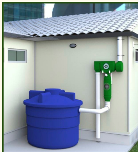
Figura 3: Sistema de recolección de agua de lluvia
