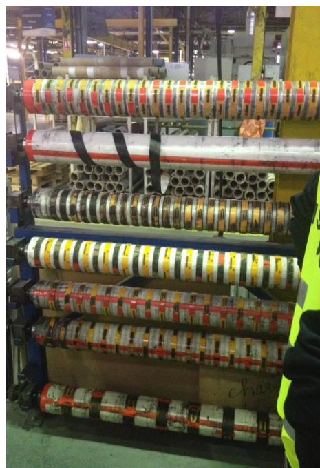
Figure 15: Les clichés d'impression dans l'usine
