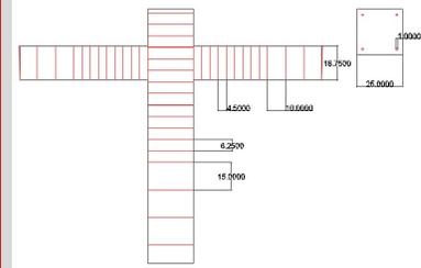
Más acero de refuerzo hacia el centro de los conexiones de pared.
