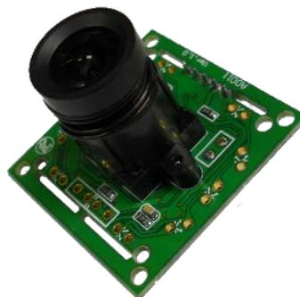
**Figure 59:** The SB101C USB camera module [28]
